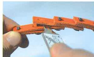
専用工具を使用して、簡単に取り付け取り外しができます。
